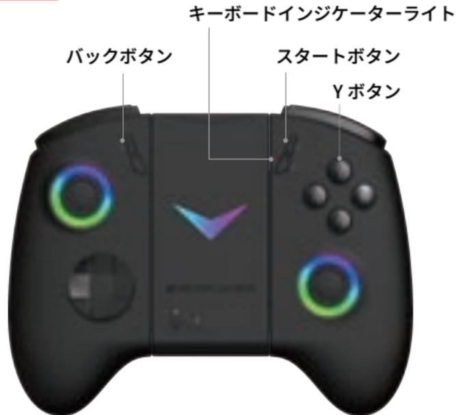
注意：ジョイスティックはできるだけ軽く回転させ、回転中は常に最大傾斜角度を保ってください。トリガーボタンを較正する際は、必ず最後まで押しってください。この動作はセットで必ず行ってください。またキャリブレーション機能を使用する際は、片方のコントローラーのみでは行えません。必ず両側のコントローラーを本体またはコネクタにつなげた状態で行ってください。
